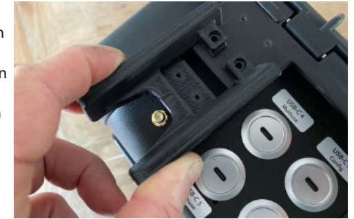
(Imagen 18) Deslizar la protección de antenas en el bolsillo previsto.
