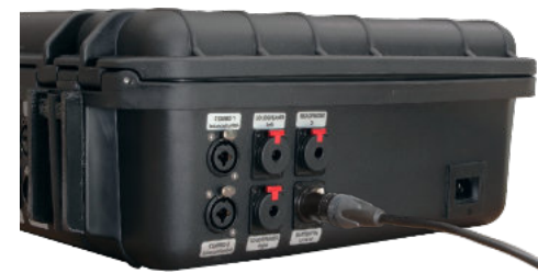
(Figure 24) Connexion de la batterie du boîtier BSS avec câble adaptateur branché
