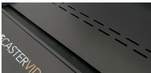
(Figure 21) Fentes d'aération du boîtier BSS
