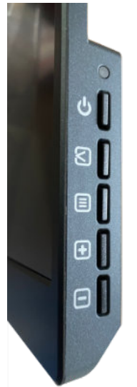
(Bild 22) Bedienelemente auf der rechten Monitorseite
