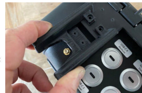
(Figure 18) Introduire le protège-antenne dans la poche prévue à cet effet. Glisser dans la poche.
