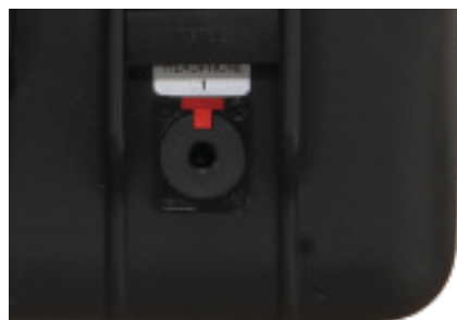
(Imagen 23) Conector de auriculares de 6,35 mm en la parte frontal del maletín.
