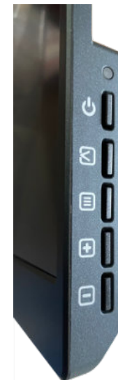
(Immagine 22) Pannello di controllo sul lato destro del monitor.
