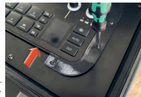
(Figure 15) Tendeur C visser dans le Rodecaster Video Case
