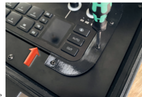
(Immagine 15) Fissare il C-Spanner nel case del Rodecaster Video
