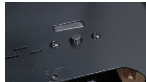
(Immagine 26) Slot per scheda MicroSD (con copertura) sulla piastra superiore
