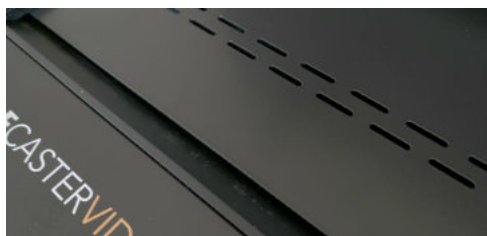
(Immagine 21) Fessure di ventilazione della case BSS.
