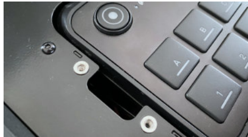
(Bild 16) Ein- und Ausbauschacht
