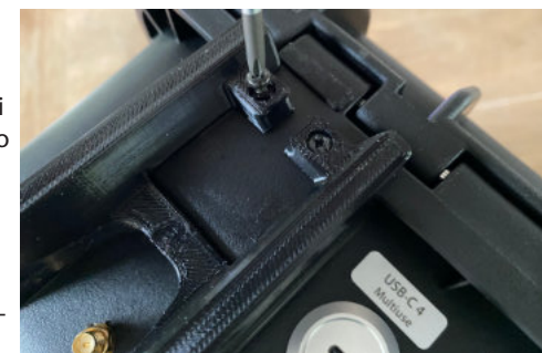
(Immagine 19) Fissare la protezione dell'antenna con le viti.
