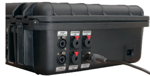
(Immagine 24) Collegamento batteria del case BSS con cavo adattatore collegato.
