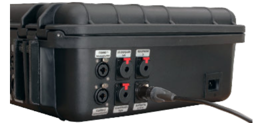
(Bild 24) BSS-Case Batterieanschluss mit angestecktem Adapterkabel
