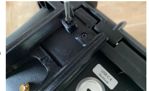
(Imagen 19) Atornillar la protección de antenas.
