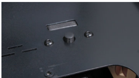
(Imagen 26) Ranura para tarjeta MicroSD (con tapa) en la placa superior.
