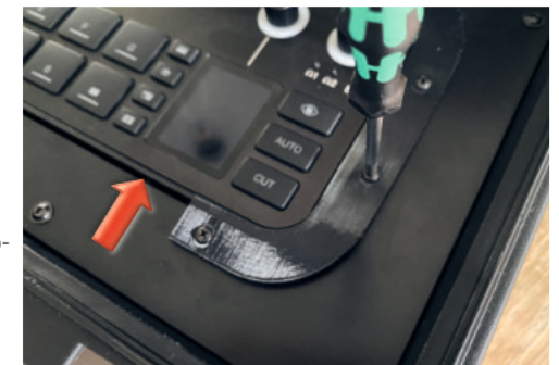
(Bild 15) C-Spanner im Rodecaster Video Case verschrauben
