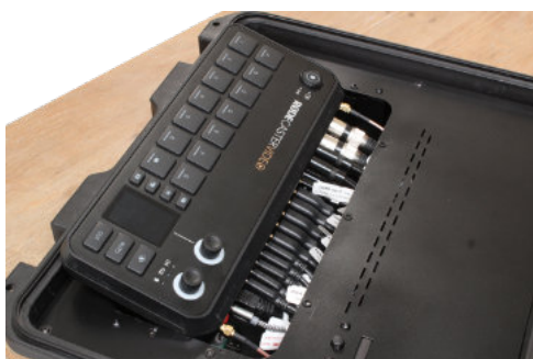
(Figure 13) tous les câbles à l'état enfilé
