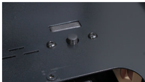
(Figure 26) Logement pour carte MicroSD (avec couvercle) sur le panneau supérieur
