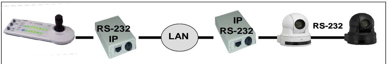
Interface de contrôle des caméras tourelles via le réseau IP
