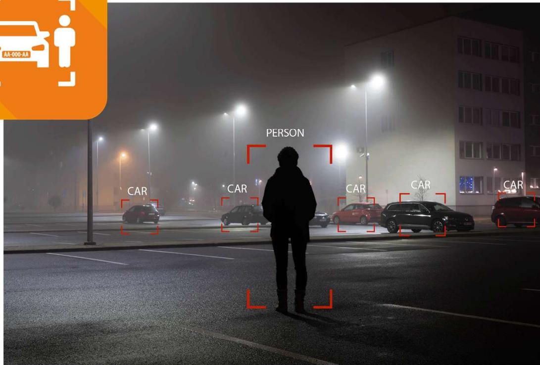
Les caméras eneo AI peuvent classer les objets en véhicules et en personnes. Cela permet une recherche ciblée dans les enregistrements. La classification des objets augmente considérablement l'efficacité de la recherche et réduit le nombre de fausses alertes.
