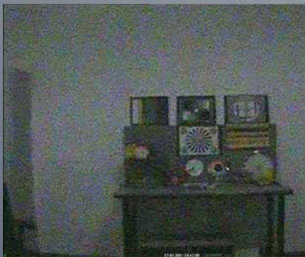
cliché de test sans 3D-DNR Le bruit de l'image se reconnaît aisément.
