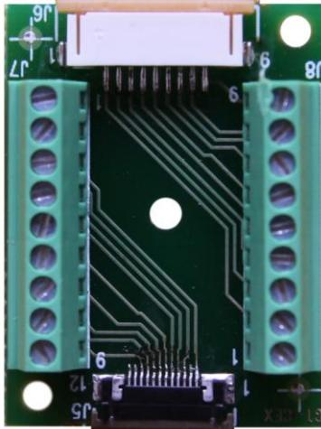
Carte entrées/sorties permettant de s'interfacer sur les nappes 9 pts des blocs caméras Sony de la Série EX. La carte GT-CEX dispose également d'une connexion capable de piloter les principales fonctions du bloc par contacts secs via un réseau de résistances.
